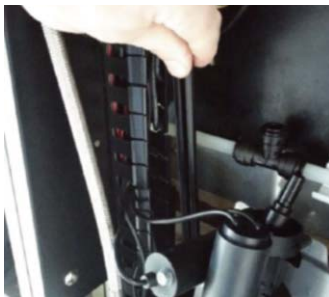
6. Remove the conduit cover
